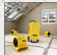
K podpore elektrických odvlhčovačov vzduchu / stavebných vysušáčov.
